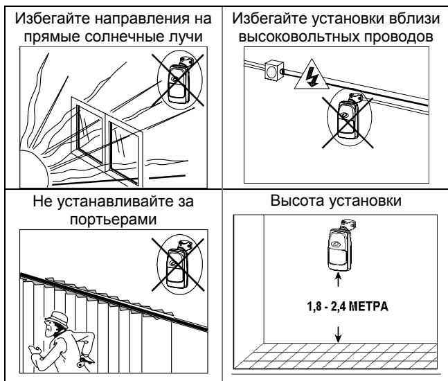
Рисунок 2. Требования к установке детекторов
