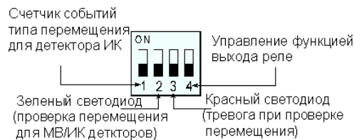
Рисунок 5. Переключатель DIP выбора режимов
